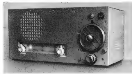
Kurzwellen-Konverter und Philips-Philetta als Spezial-KW-Empfänger im gemeinsamen Gehäuse
