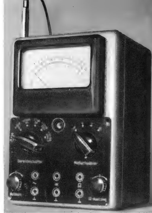
Das FUNKSCHAU-Röhrenvoltmeter M 561 für Gleich- und Wechselspannungsmessungen sowie zur Prüfung von Widerstandswerten
