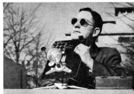
Eine Batterie aus 8 Silizium-Fotoelementen zur Gewinnung elektrischer Energie aus dem Sonnenlicht
